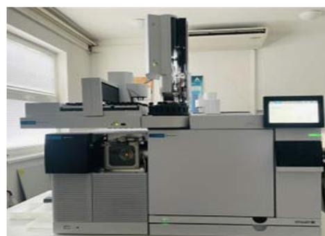
Figura 4: Instrumentação GC/MS/MS (QqQ) utilizada para análises de PCNs
